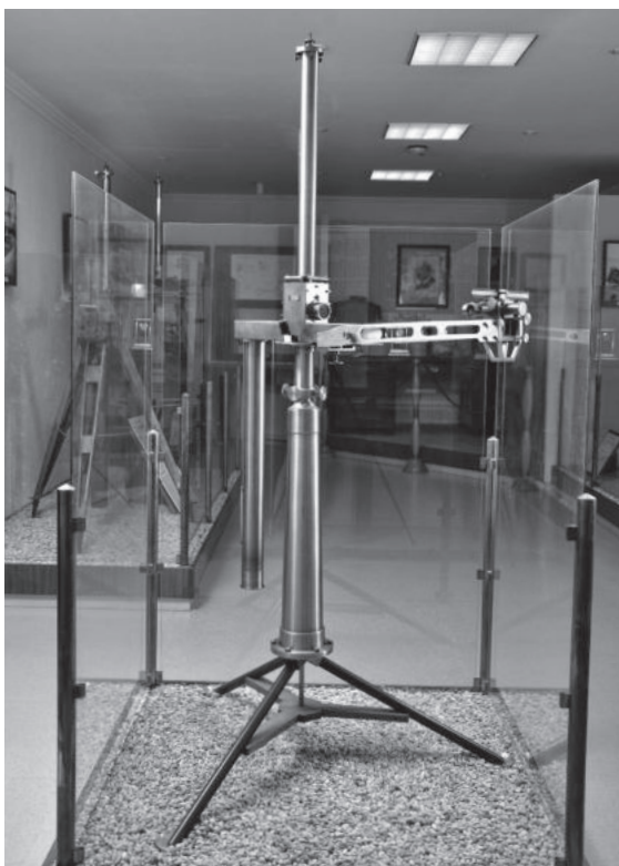
Egyszerű nehézségi variométer (Balatoni inga, 1898). A horizontális variométer továbbfejlesztett változata. Eötvös ezzel a műszerrel végezte méréseit 1901-ben és 1903-ban a Balaton jegén. SZTFH Eötvös Loránd Emlékgyűjteménye, Fotó: Lantos Zoltán.
